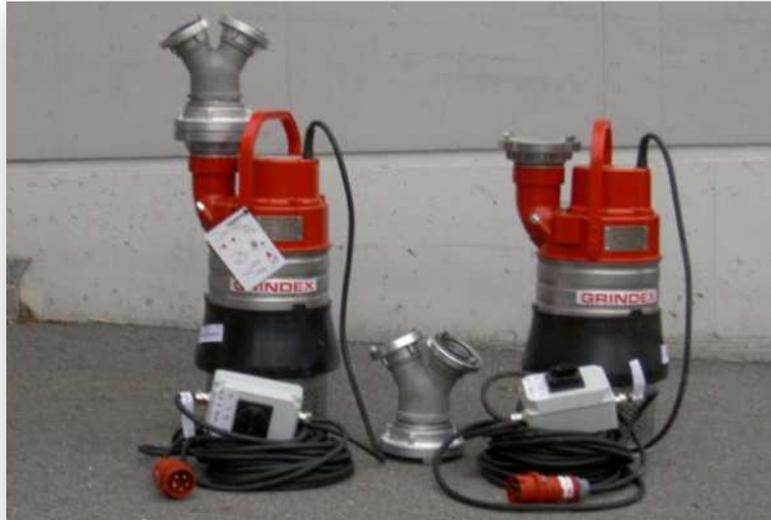
Schwere Schutzwasser-Tauchpumpen, geeignet für jegliche Art von Einsätzen. Ausgestattet mit einer Motorschutzeinrichtung, elektronischen Drehrichtungsschutz sowie Thermo-fühlern, und Trockenlaufsicher
