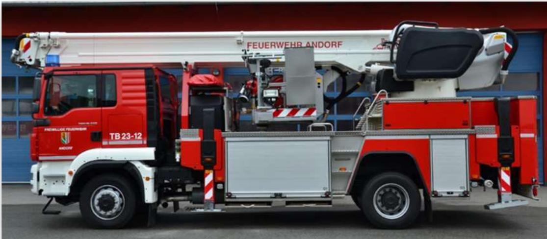
Fahrzeug zur Menschenrettung aus Höhen und Tiefen. Weiters kann das Fahrzeug zur Brandbekämpfung und für die Durchführung kleinerer technischer Hilfeleistungen eingesetzt werden.
