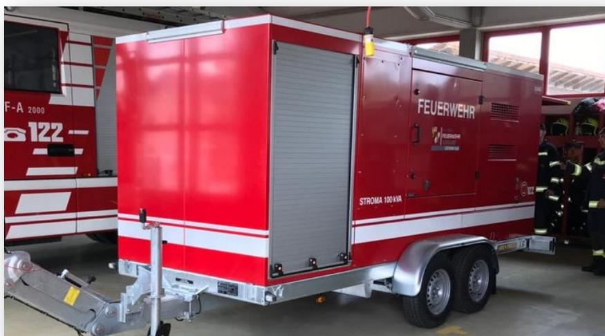
Autarke mobile Notstromversorgung mit Fixsatz „Strom“ und „Beleuchtung“ auf Anhänger mitgeführt. Einspeisevorrichtung (nur bei vorinstallierten externen Einspeisemöglichkeiten) mit Zubehör „Strom“. Zusätzliche Verwendung als Pumpeneinheit zur Versorgung der zwei am Stützpunkt vorhandenen Schmutzwassertauchpumpen GRINDEX MASTER N (bis zu 4 Pumpen sind gleichzeitig zu betreiben)
