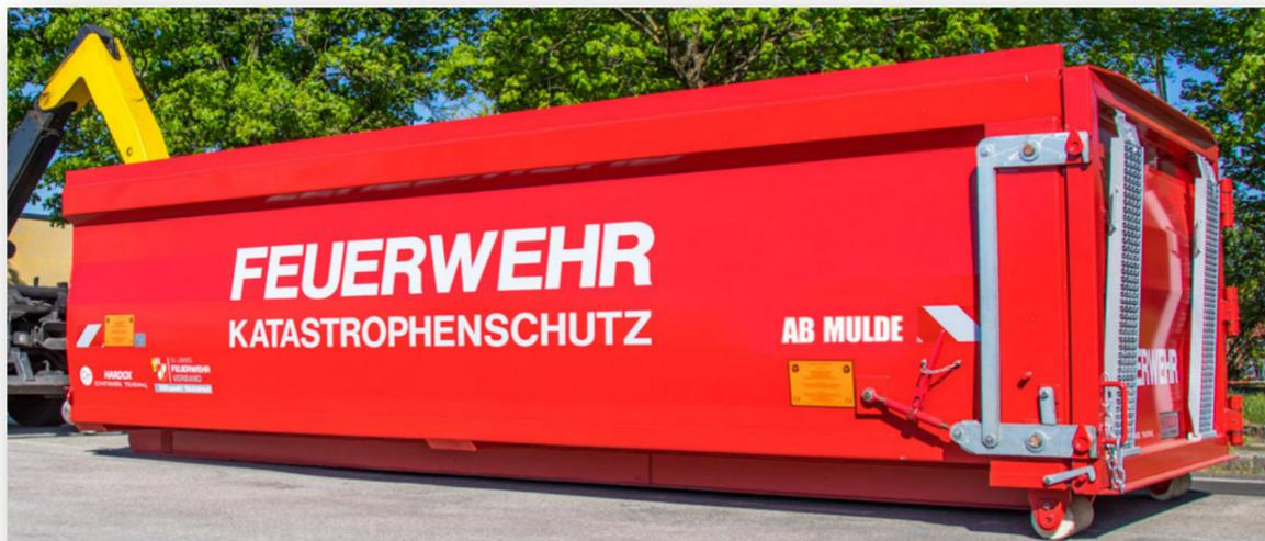
Multifunktionaler, offener Abrollcontainer (AB) im Format 20 Fuß (Länge ca. 6,40 m) zum Transport mit Wechselladefahrzeug (WLF) mit Multilift-Hakengerät geeignet. „Flugtauglich“
