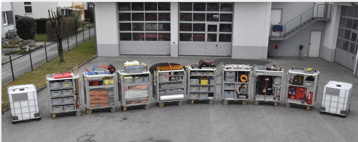
Rollcontainer mit div. Gerätschaften zum Auffangen, Abdichten und umpumpen bei Unfällen mit Mineralölen, Säuren, Laugen und gefährlichen Stoffen auf der Straße, Schiene, im Schiffsverkehr und in Betrieben.
